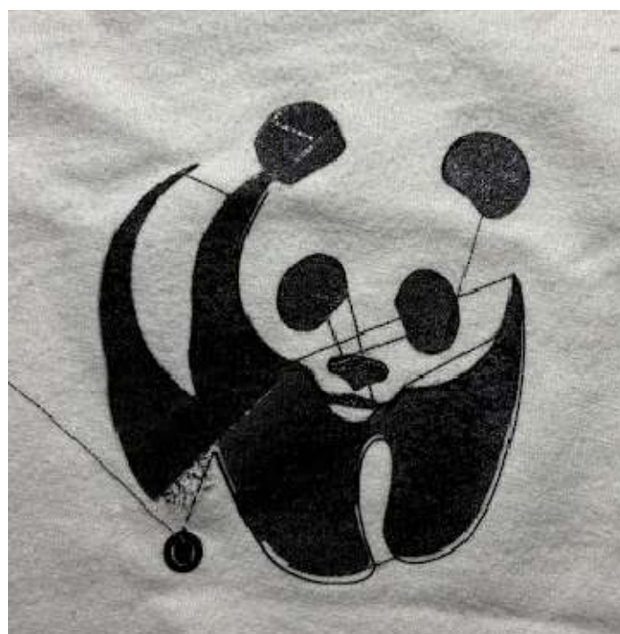
Annexe 6 : Impression avec vitesse trop rapide
