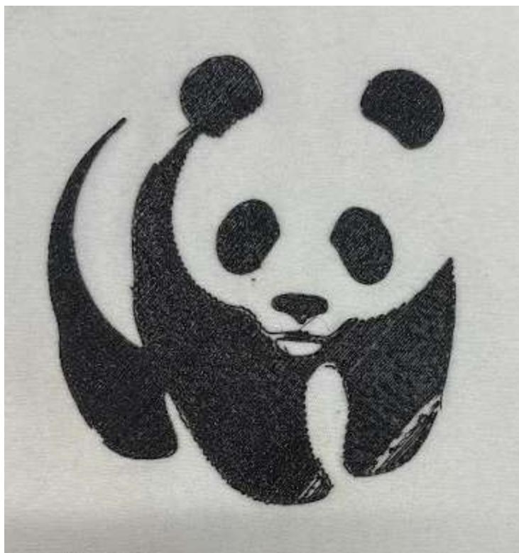
Annexe 5 : Impression trop épaisse (0.5mm)
