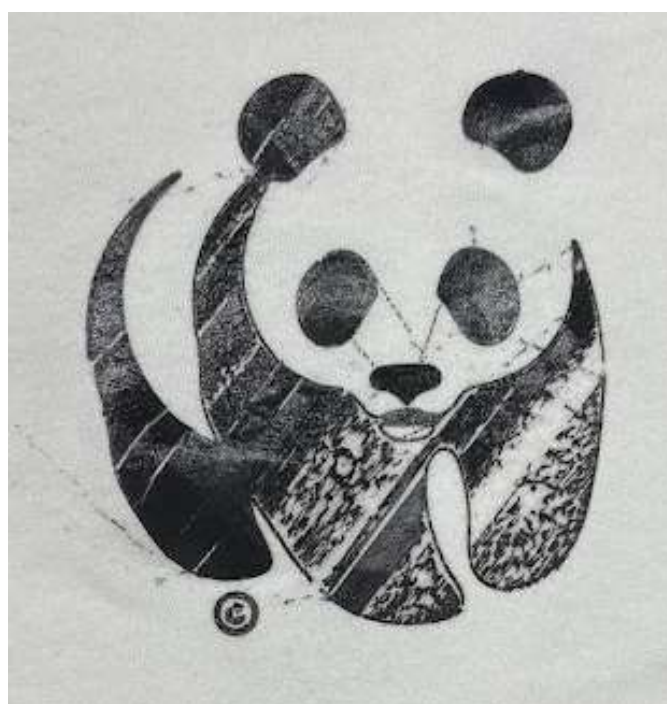
Annexe 4 : Impression avec hauteur de buse trop élevée
